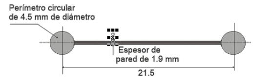
**ESPECÍMEN DE ENSAYO:**
